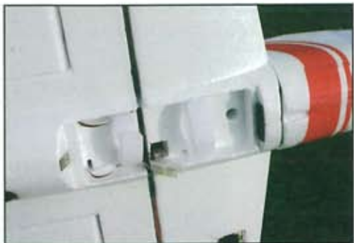
Le logement de l'accu, particulièrement accessible.
