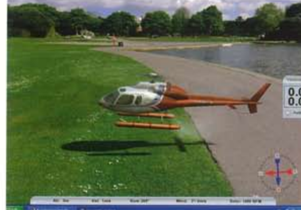
▲ Beispielsicht des Monitorbildes: unten eingeblendet die Fluginformationen, rechts darüber der Windkompass (blauer Pfeil = Windrichtung, roter Pfeil = Richtung des Flugzeugs). Das Variometer (Anzeige von Steigen und Sinken und besonders für den Segelflug sehr hilfreich) kann am rechten Bildrand eingeblendet werden.
